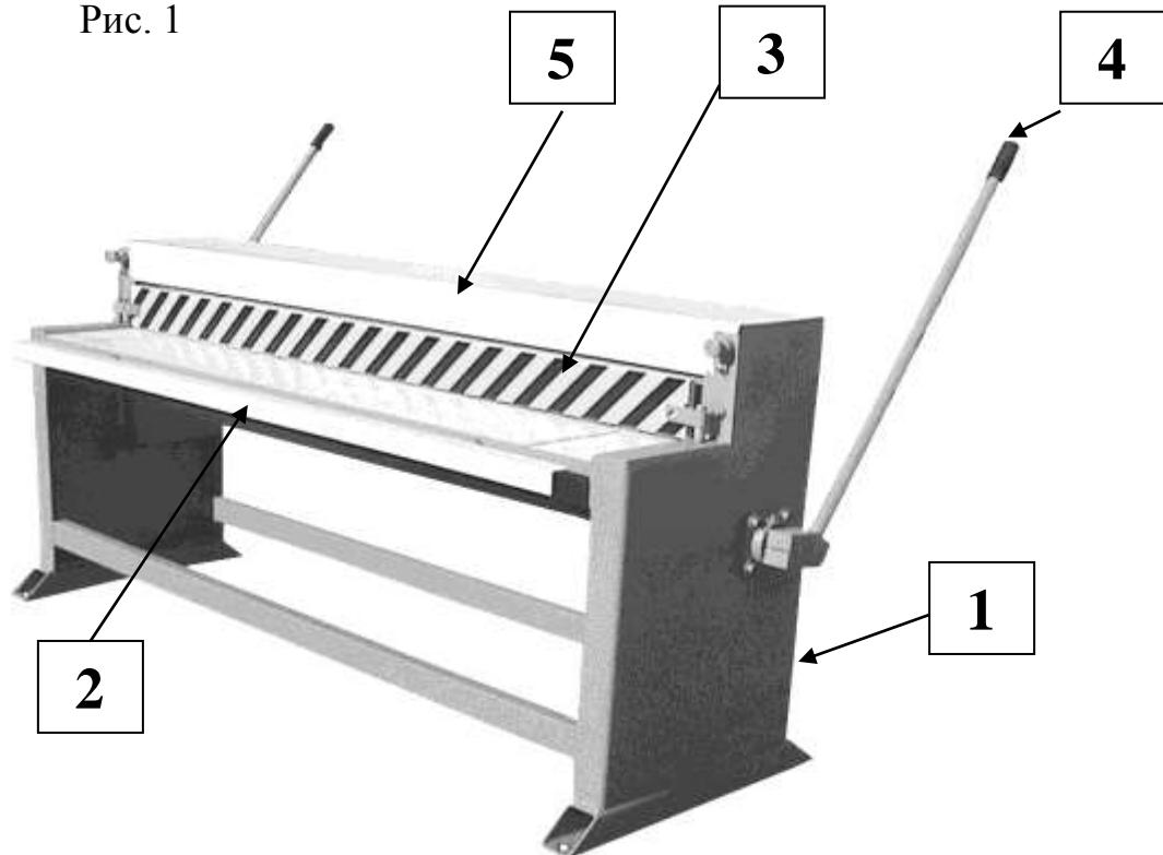
Гильотина состоит из станины (1) с направляющим столом и режущим ножом, телескопической опоры (2), прижимной балки (3), рычага с системой привода (4), подвижной балки с режущим ножом, находящейся под кожухом (5).
